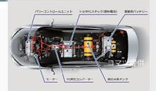
トヨタ燃料電池車の仕組み
